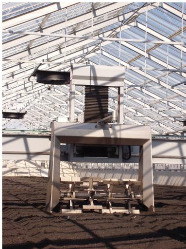
**Cas des serres à mélange de boue :** Trois autres procédés fonctionnent sur ce principe : Ils ne déplacent pas les boues d'une extrémité à l'autre de la serre mais ont la particularité de mélanger les boues fraîches aux boues en cours de séchage.
