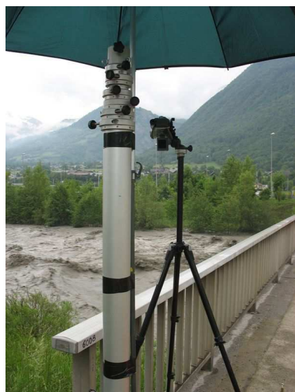
Mesure des vitesses de surface par LSPIV lors de la crue du 28/05/2008 à St Avre
