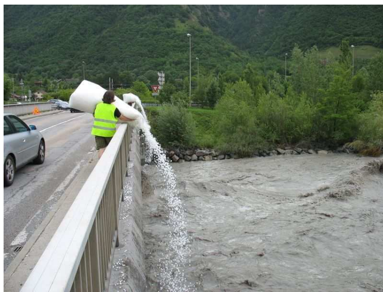
Mesure des vitesses de surface par LSPIV lors de la crue du 28/05/2008 à St Avre
