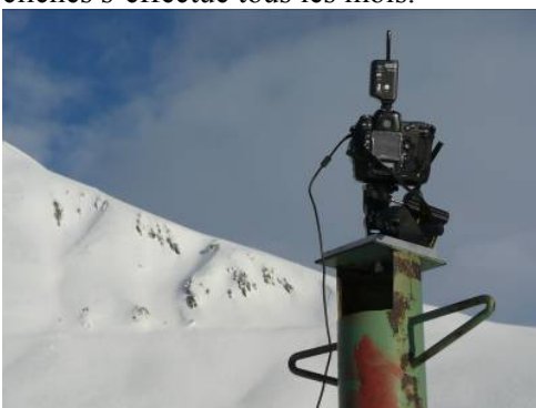
Fig. 3. Boîtier Nikon et son relais radio (Lautaret)
