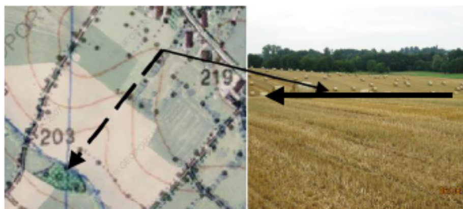
Repérage d'un talweg par observation des courbes de niveau sur une carte
