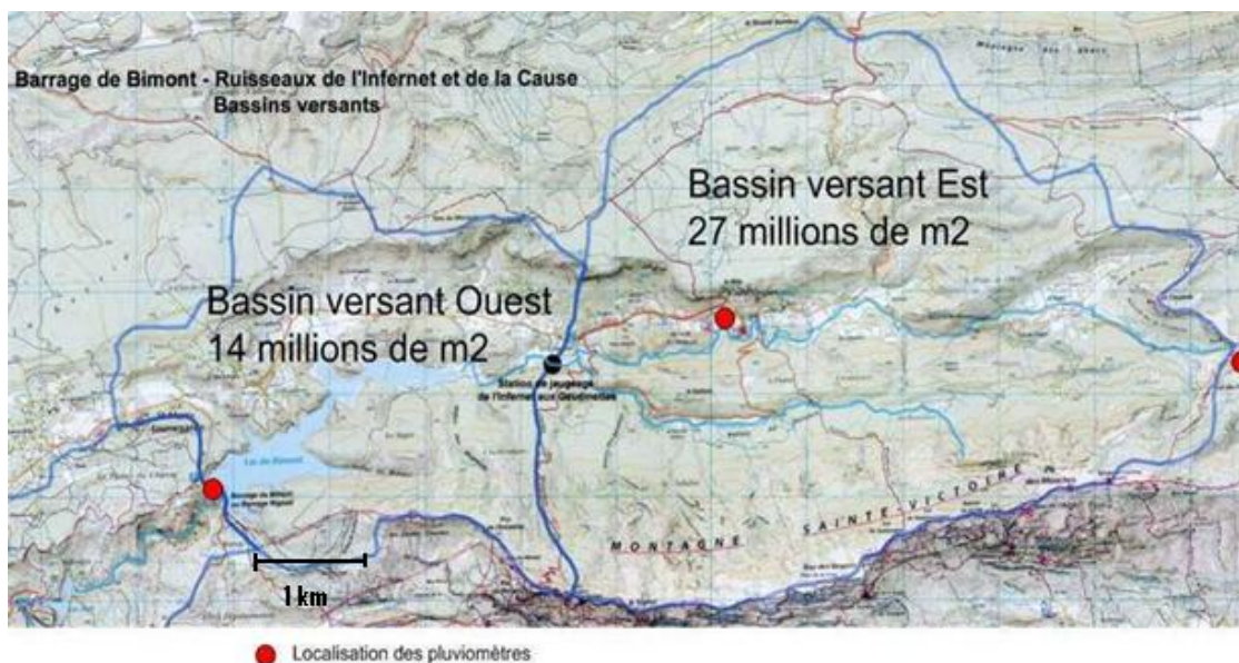
Figure 17 : Carte de délimitation des sous-bassins versant de la retenue de Bimont (source : SCP)
