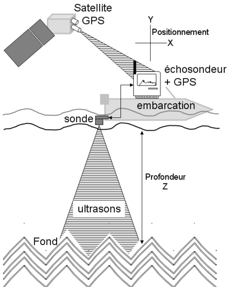
Figure 2 : Principe de l'échosondage couplé GPS
