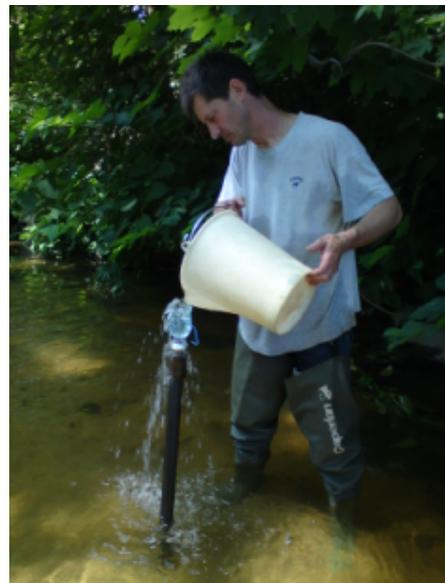
Figure 3 : Slug-test ou choc hydraulique pour mesurer la conductivité hydraulique  $k$ . (crédit Photo P.Breil)
