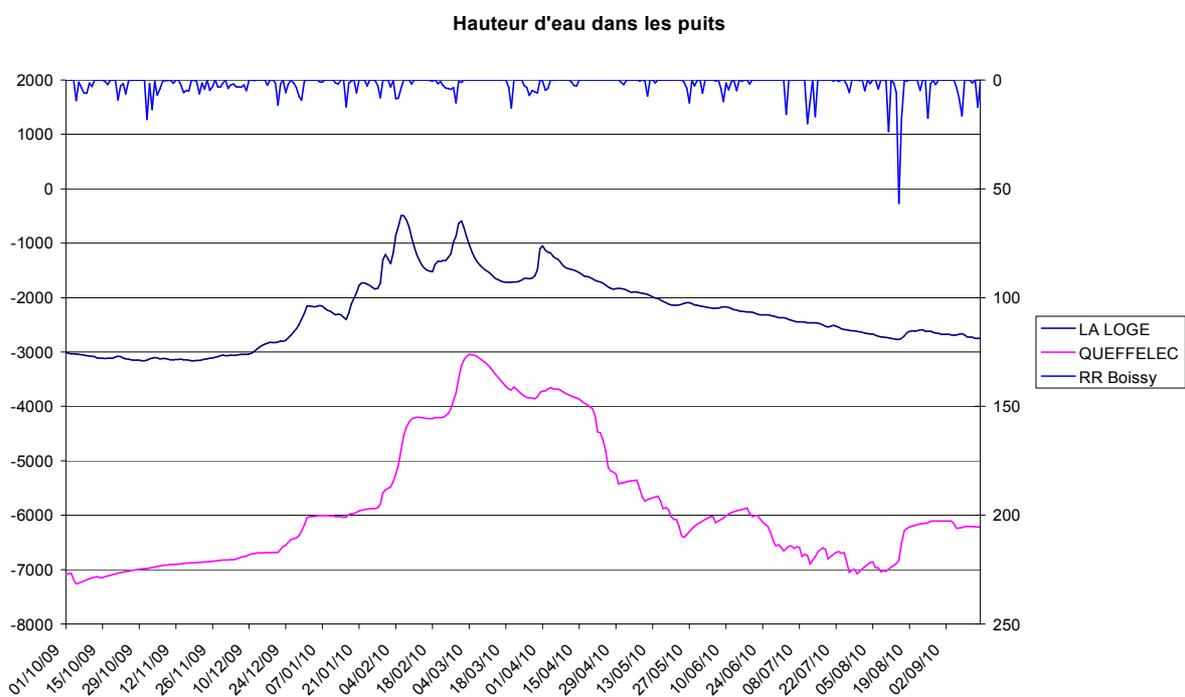
Figure 14 : Battance de la nappe mesurée au niveau des puits de La Loge et de Queffelec à Goins et pluviométrie du poste 28.
