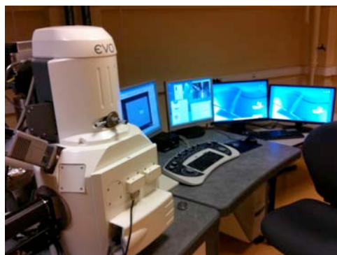
Fig.4 : M.E.B. EVO50 équipé d'une sonde pour la microanalyse aux Rayons X
