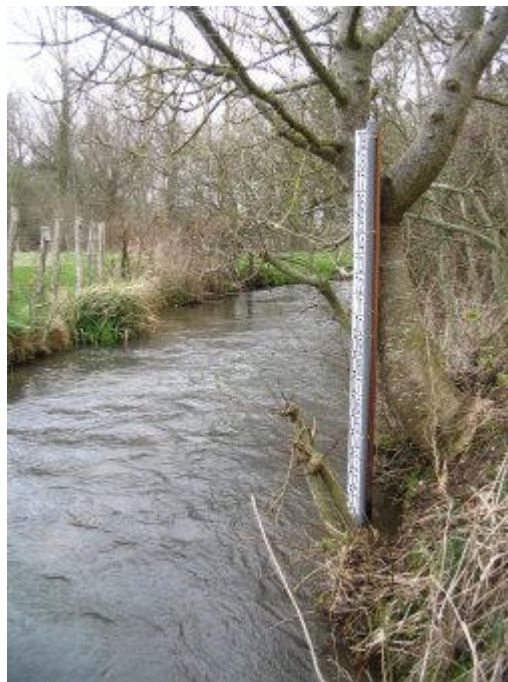
Figure 44 : Echelle à maxima installée sur la Nosle.
