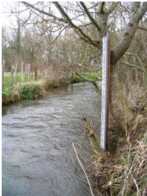
**Figure 44** : Echelle à maxima installée sur la Nosle.
