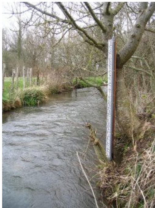
Figure 44 : Echelle à maxima installée sur la Nosle.
