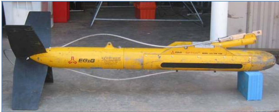
Figure 13 : exemple de système tracté par un navire comprenant les deux transducteurs (Hamilton, 2005).
