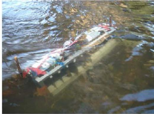
Figure 1 : photographie d'un rack contenant les coupons en acier inoxydable déposé dans la Vézère (photographie S. Boulêtreau)
