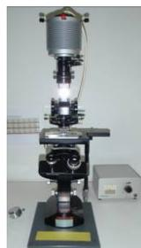
**Figure 11: Microscope inversé utilisé pour effectuer les comptages.**
