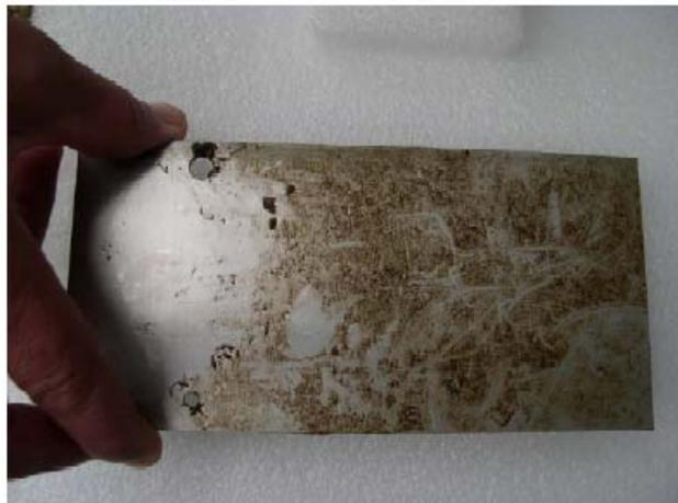
Figure 2 : photographie d'un coupon en acier inoxydable colonisé par du biofilm épilithique (photographie S. Boulêtreau)
