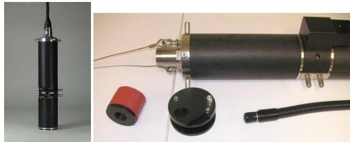
Figure 3: La sonde fluorimétrique à gauche : en mode planctonique (FluoroProbe) et à droite : la sonde avec l'adaptateur benthique.
