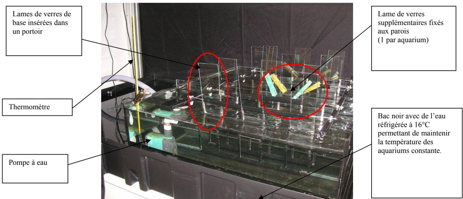
**Figure 8: Dispositif de l'Expérience en canaux expérimentaux : l'aquarium du premier plan est en condition oligotrophe et l'aquarium en second plan est en condition eutrophe.**
