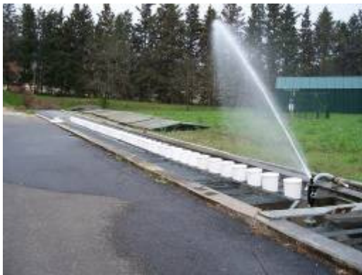
Figure 2 : dispositif de mesure extérieur, mesures de pluviométries sur la turbine Eagle 750 S (a) et intérieur avec cloche de mesure (b)
