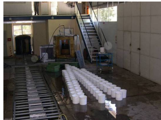
Figure 2 : dispositif de mesure extérieur, mesures de pluviométries sur la turbine Eagle 750 S (a) et intérieur avec cloche de mesure (b)
