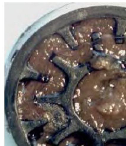
Goutteur présentant le développement d'un biofilm au niveau du labyrinthe.
