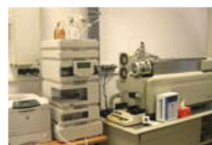
Chromatographie en phase liquide avec double détection par spectrométrie de masse (LC-MSMS) pour l'analyse des médicaments et des pesticides.
