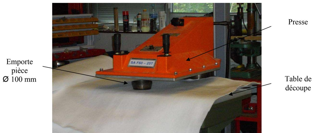
**Figure 25 :** Découpe des échantillons
