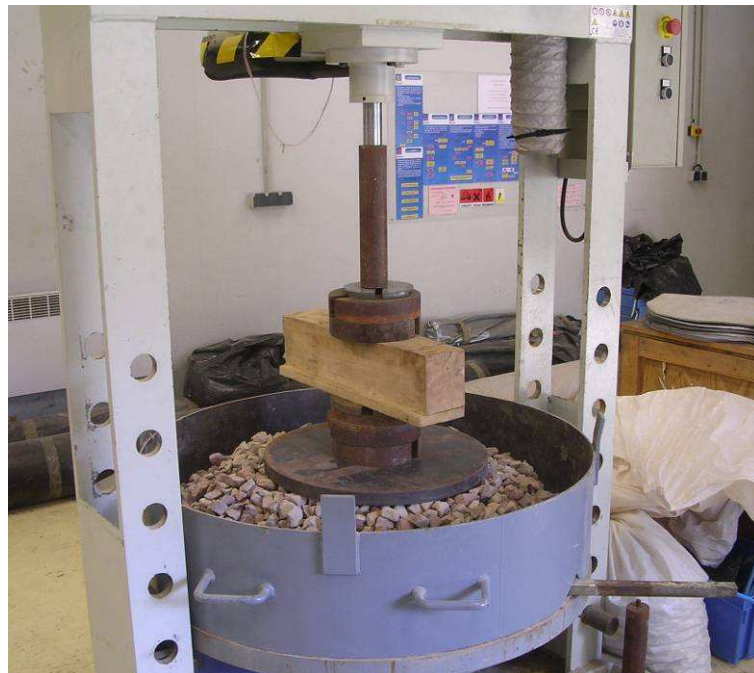
Figure 18 : Appareillage de l'essai d'endommagement statique utilisé au laboratoire du Cemagref d'Antony
