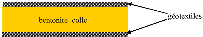
Figure 8 – Schéma d'un géotextile bentonitique collé
