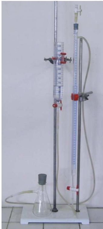
Figure 2 : Détermination de la teneur en carbonates (NF P 94-048)
