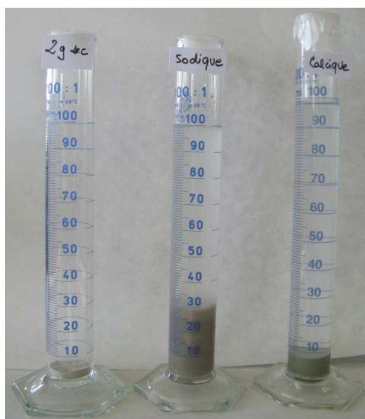
Figure 1 : Détermination de l'indice de gonflement selon la norme XP P 84-703 et ASTM D5890
