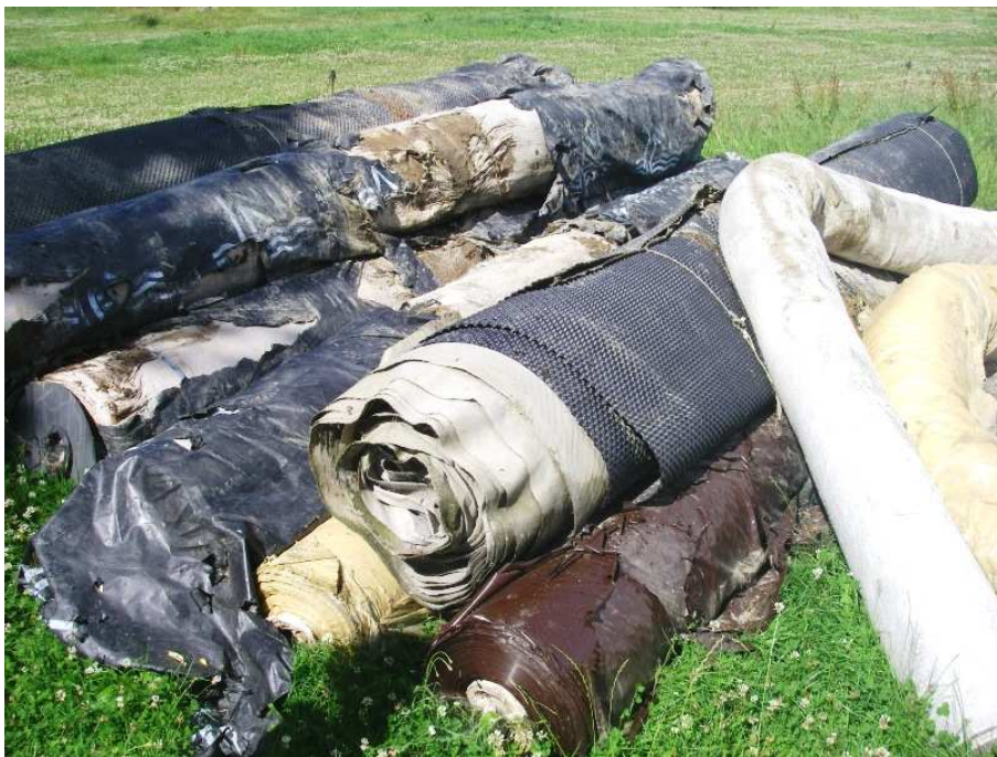
Figure 4 – Stockage de rouleaux de géosynthétiques ne respectant pas les règles de l'art : présence de végétation, rouleaux non emballés, non isolés du sol, mal empilés (photo T. Gisbert)
