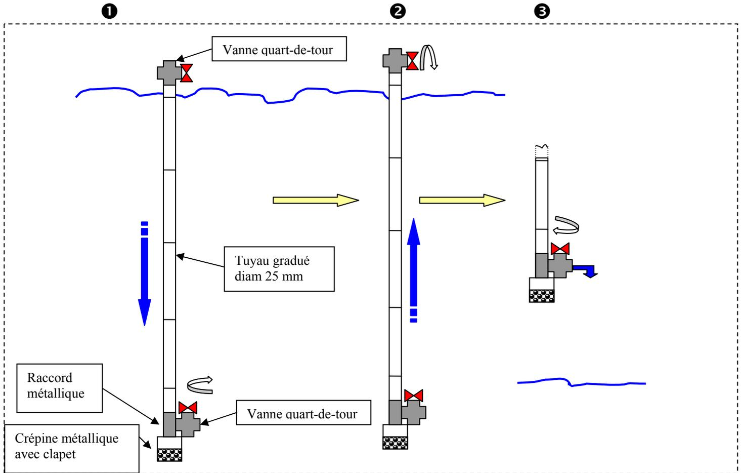
❶ Après fermeture de la vanne du fond, le tuyau est descendu lentement dans la colonne d'eau jusqu'à la profondeur maximale de prélèvement souhaitée (fin de la zone euphotique) ;
