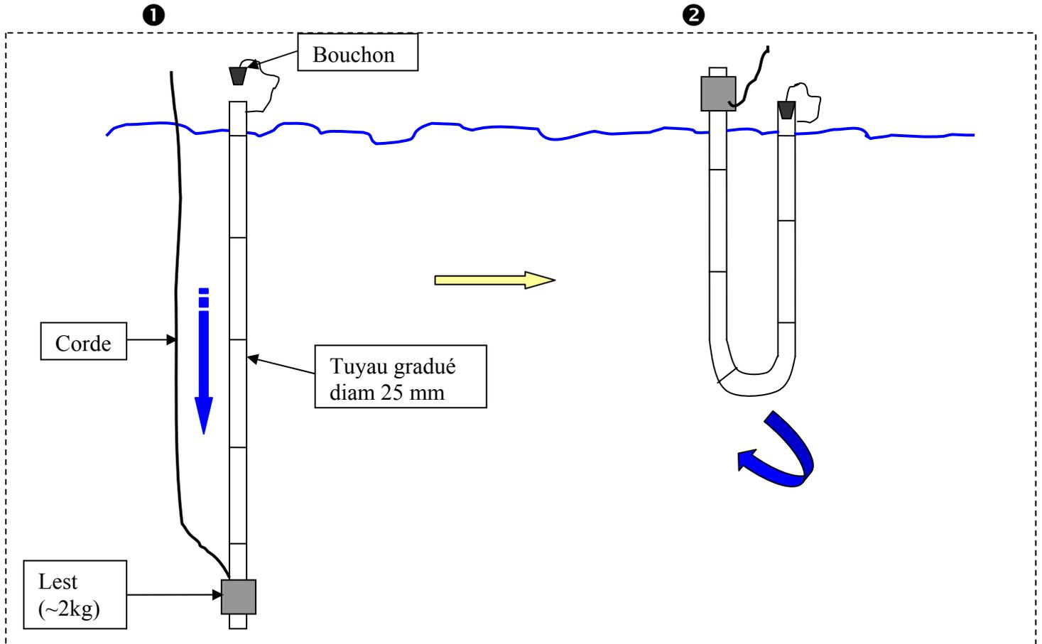
❶ Le tuyau est descendu lentement dans la colonne d'eau jusqu'à la profondeur maximale de prélèvement souhaitée (fin de la zone euphotique) ;
