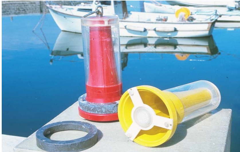
Photo de la bouteille de prélèvement intégré INRA (Pelletier & Orand 1978)
