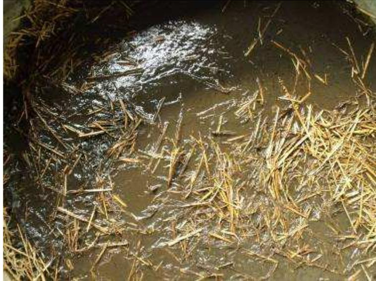
**Figure 15 : Aperçu du bac de filtration gravitaire après remplissage avec de la boue concentrée.**
