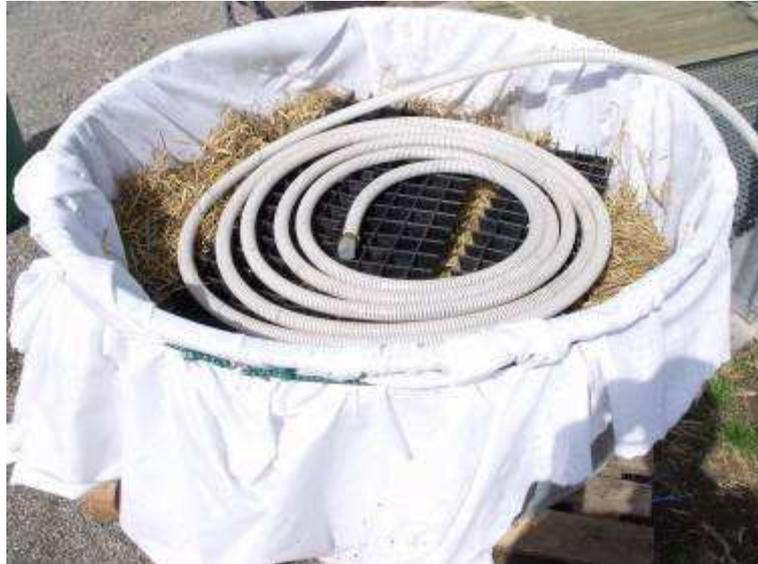
**Figure 8 : Filtration gravitaire par aspersion lente. Le bac est ceint par un géotextile, pour ralentir l'écoulement et l'aspersion se fait à travers un tuyau perforé, placé en rond sur l'amas de paille.**
