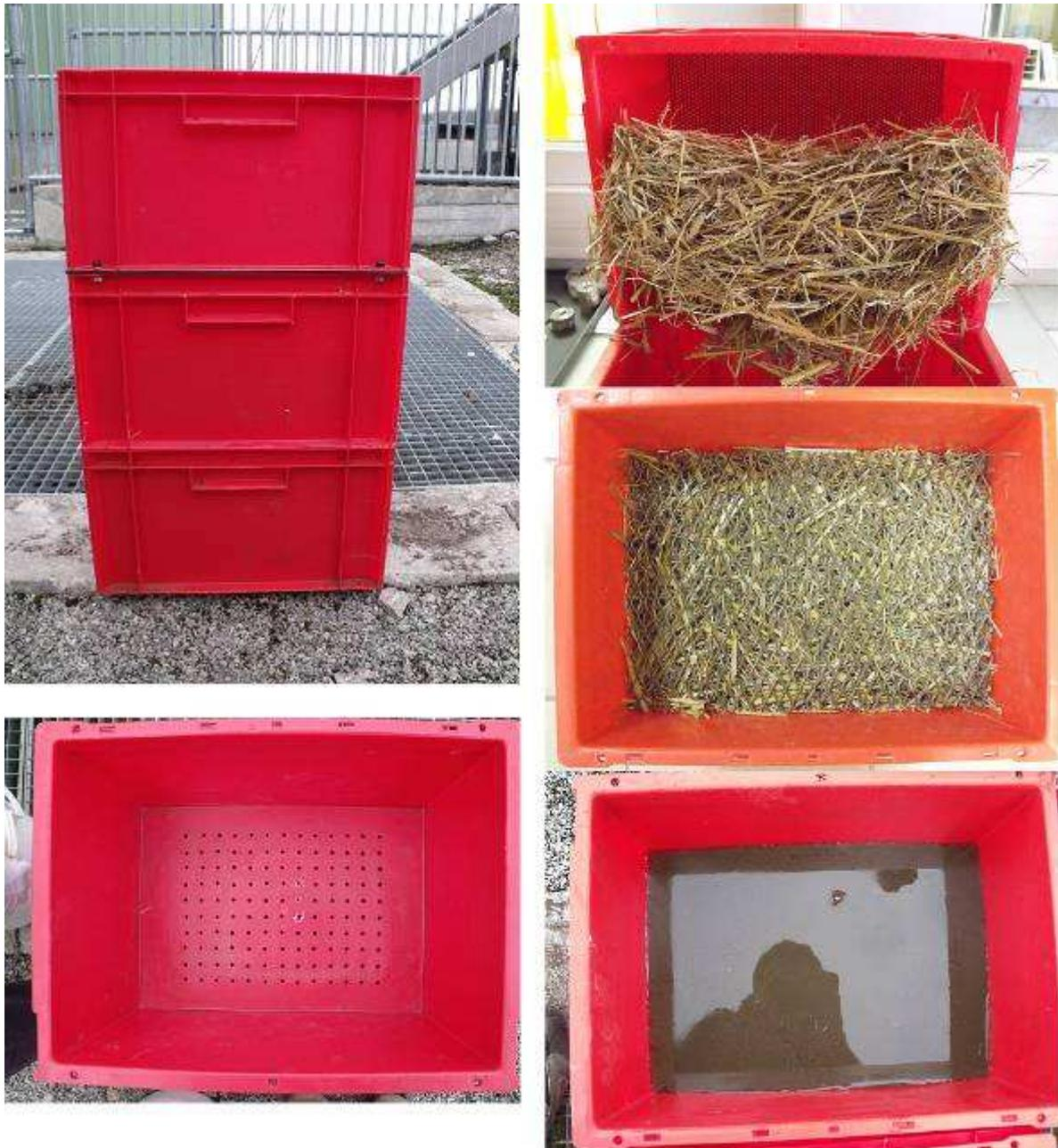
**Figure 1 : Système de filtration sur lit de paille seule.**
