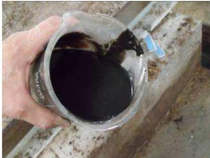
**Figure 11 : Consistance de la boue obtenue après épaississement par filtration ascendante et avant filtration gravitaire.**
