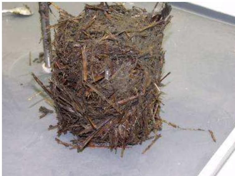
**Figure 10 : Tenue en tas d'un échantillon de fumier de boue, à 12% de MS. Cette siccité a été mesurée sitôt l'expérience terminée, ce qui signifie qu'un suintement était encore observé.**
