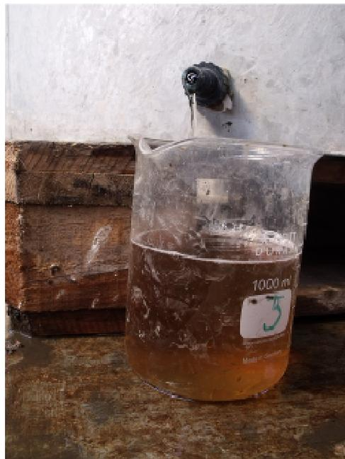
**Figure 16 : Filtrat recueilli après l'étape de filtration gravitaire. La coloration jaune foncé est due à la paille qui colore le filtrat.**
