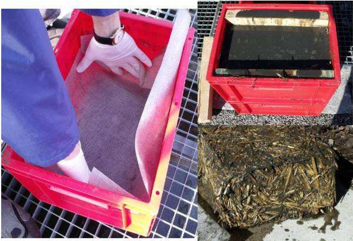
Figure 4 : Essais de filtration gravitaire sur paille comprimée en utilisant un géotextile.
