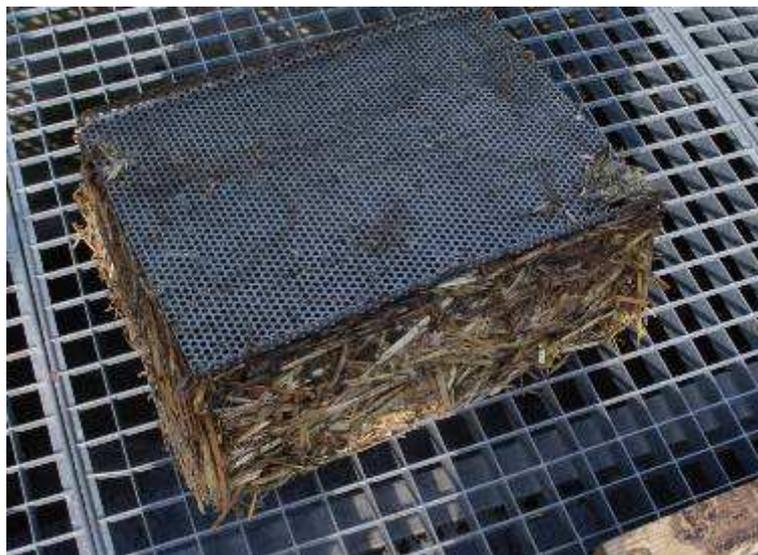
**Figure 3 : Rétention de la matière solide à proximité de la grille lorsque la paille est comprimée.**
