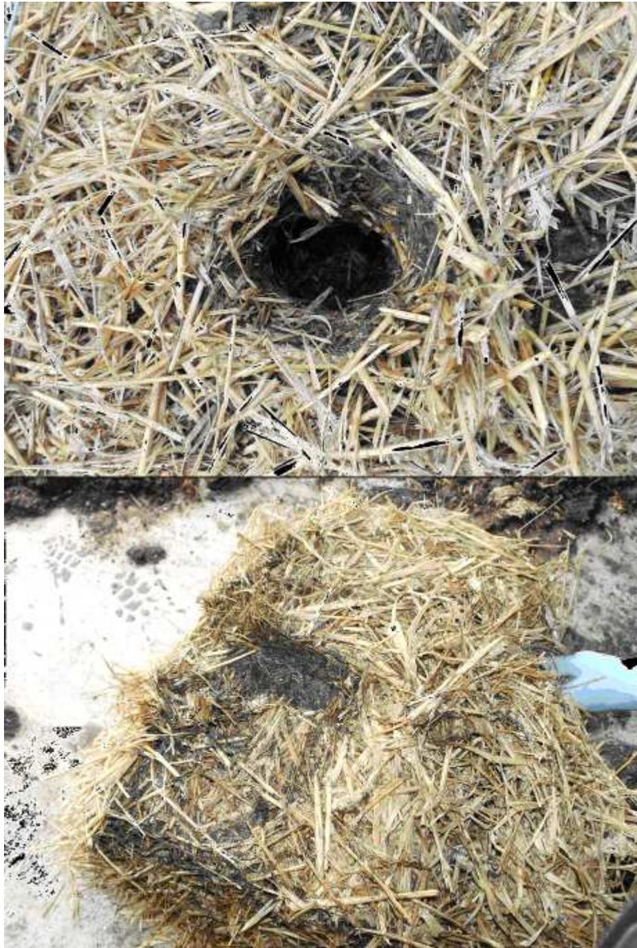
**Figure 6 : Ecoulement préférentiel de la boue dans le massif pailleux, jusqu'aux parois.**
