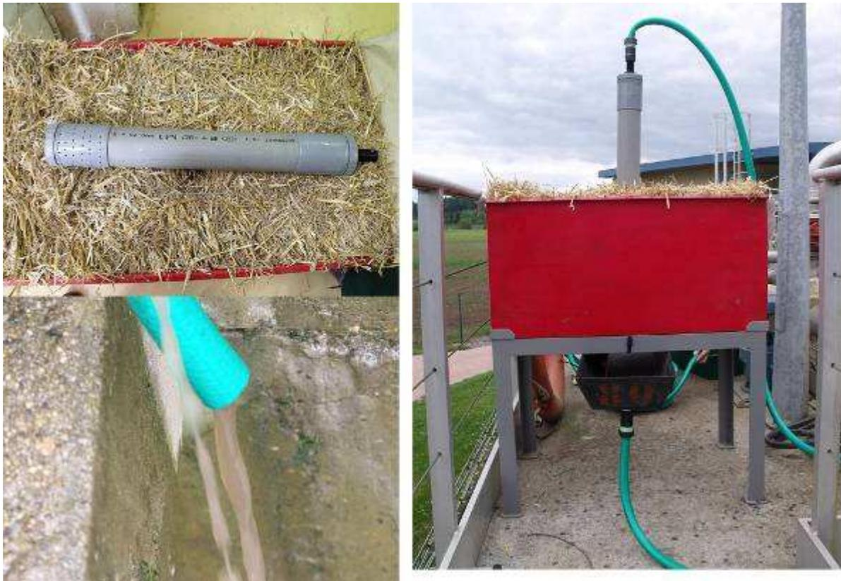
**Figure 5 : Essais par injection ponctuelle et continue de boue dans un amas de paille comprimée.**
