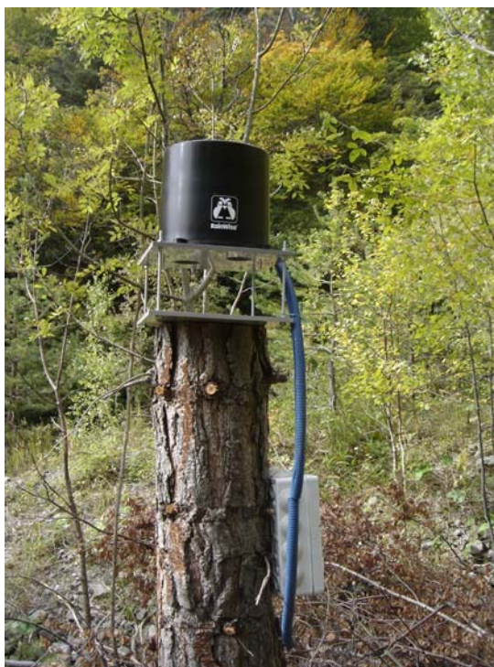
Figure 22. Pluviographe installé dans le haut bassin du Manival en octobre 2008
