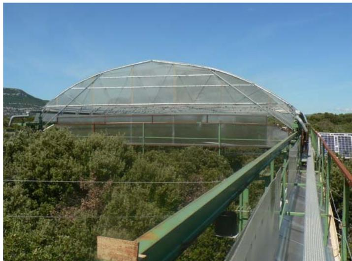
Photographie 1. Les dispositifs d'exclusion de pluie du site expérimental de Puéchabon. A gauche exclusion partielle de pluie ou « throughfall displacement experiment » avec 30% de l'aire couverte de gouttières de PVC. A droite vue du toit mobile permettant l'exclusion totale des précipitations.
