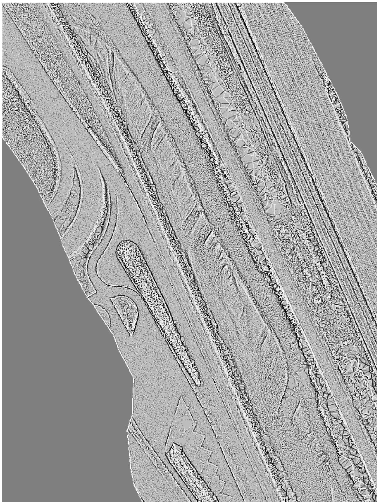
FIGURE A.5 – Visualisation après application d'un filtre Laplacien
