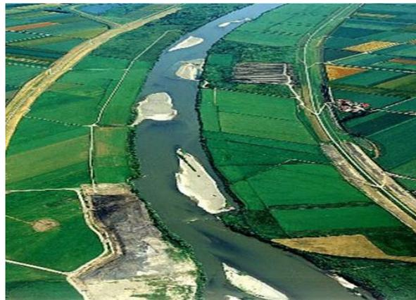
FIGURE 1.1 – Banc de gravier alterné
