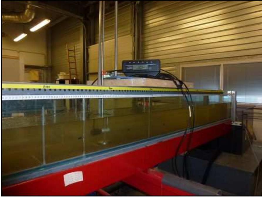
**Photo 1 : courantomètre sur perche dans le canal d'essai**
