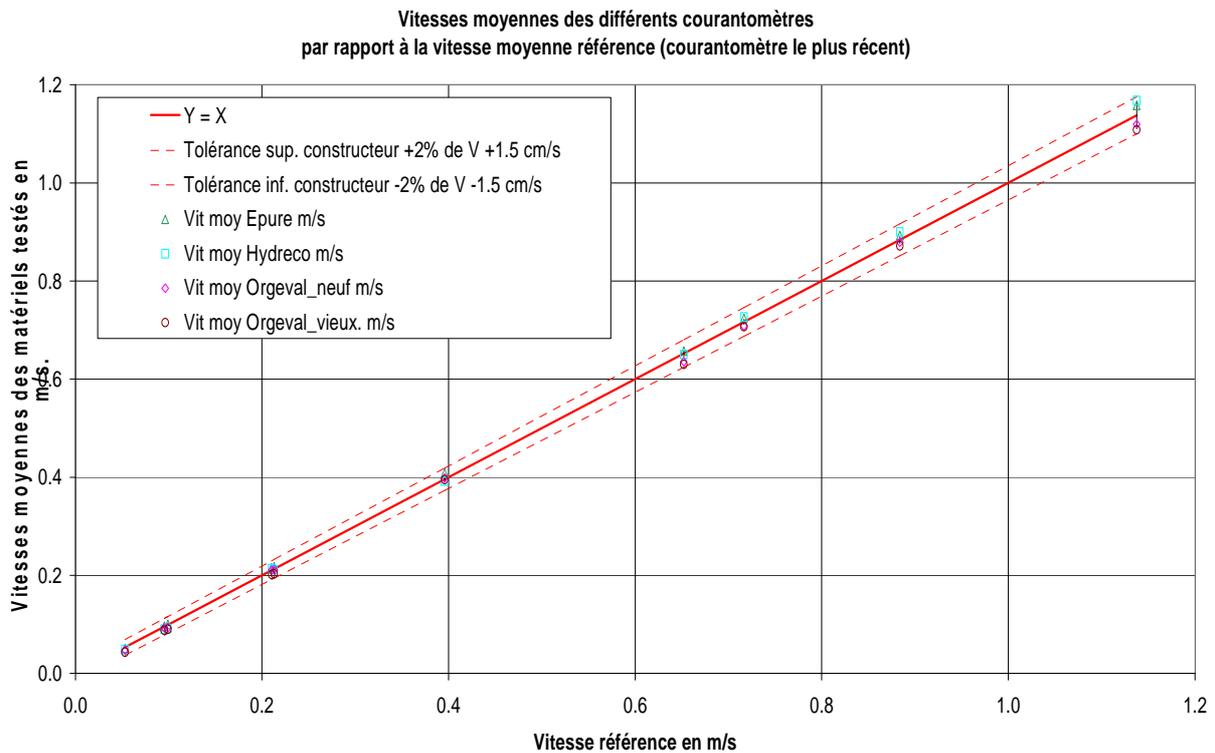
**Figure 1: Vitesses moyennes des différents courantomètres dans le couloir de tolérance de la vitesse référence.**
