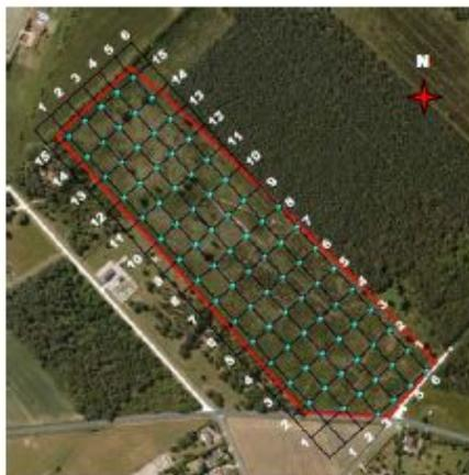
Figure 2 : Exemple d'implantation d'un réseau de 79 placettes circulaires dans une régénération naturelle
