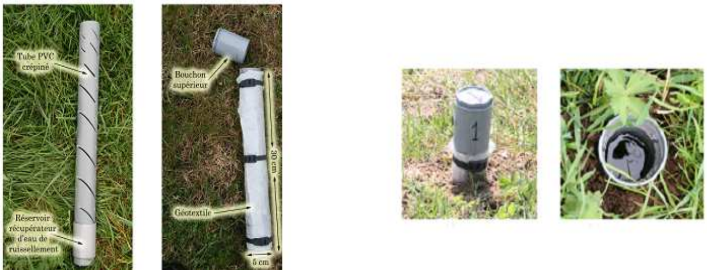
Figure 26 : Illustration des pièges à eau, installés sur le bassin du Mercier.
