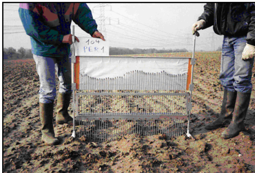
Fig. 8 - Cliché perpendiculaire à la direction des rangs, permettant ultérieurement la numérisation des altitudes relatives des aiguilles.
