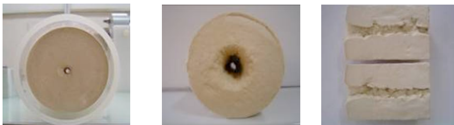
Figure 4. Exemple d'échantillon érodé au Hole Erosion Test (HET). Photo DR Cemagref
