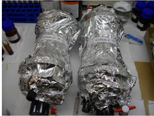
Figure 5 : cellule de mesure des coefficients de diffusion sous hotte recouvertes de papier aluminium pour éviter le phénomène de photoxydation
