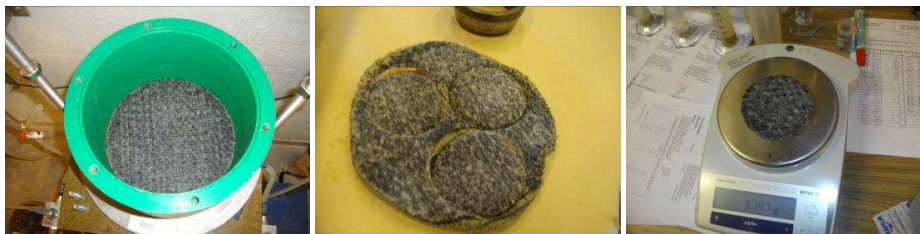
Figure 3 : vue du GSB dans l'oedoperméamètre, du prélèvement de trois éprouvettes et de la pesée d'une éprouvette avant mise en place dans la cellule de mesure
