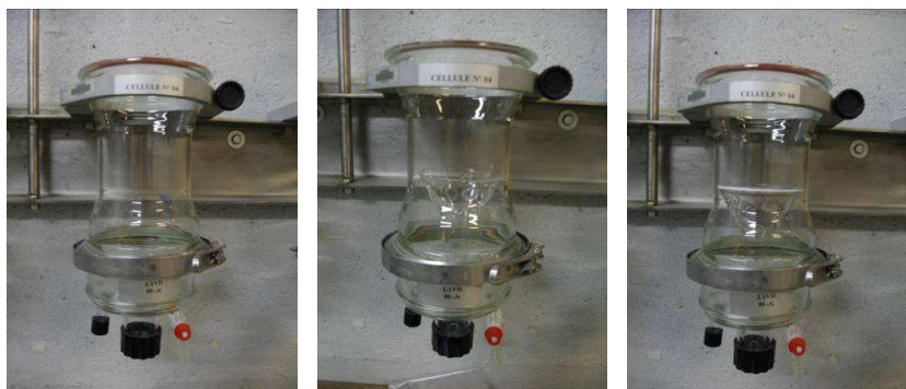
Figure 2 : détails du montage de la partie inférieure de la cellule de diffusion, avant mise en place de l'entonnoir, après mise en place de l'entonnoir et après mise en place de la plaque en inox fritté
