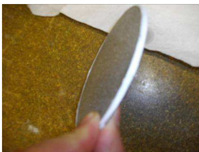
Figure 1 : plaque en inox fritté avec ruban de téflon
