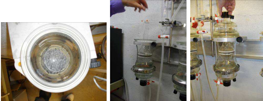
Figure 4 : mise en placé de l'éprouvette de GSB dans la cellule et fermeture de la cellule
