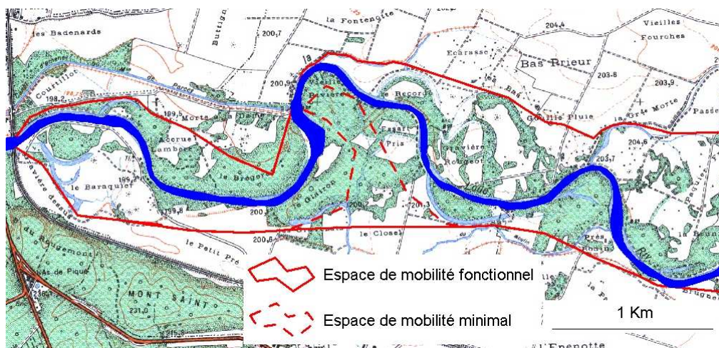
Figure 3. Vue d'une partie de l'espace de mobilité proposé sur la Loue aval (Malavoi, 2006 1 ). Les protections de berges existantes doivent être enlevées à court terme pour restaurer les processus géodynamiques naturels (érosion, dépôts...).
