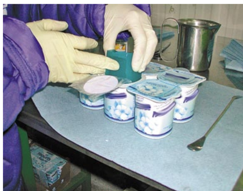
◀ Photo 1 – Remplacement du yaourt par un gel, avec l'enregistreur de température placé en périphérie.
