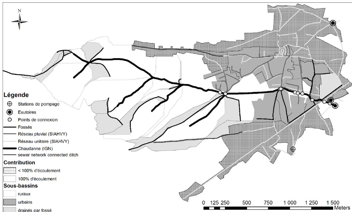
*Figure 4.14: Détermination des sous bassins ruraux et urbains sur le bassin versant de la Chaudanne. Les zones pour lesquelles on indique un pourcentage d'écoulement <100% correspondent à des aires drainées en temps normal vers la station d'épuration par le réseau unitaire, mais qui débordent dans le cours d'eau principal en cas de débordement au niveau des déversoirs d'orage (Jankowsky et al., 2011a).*
