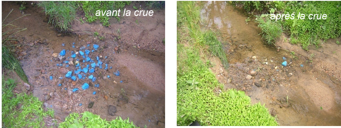
Figure 6.52: Illustration de l'utilisation de galets peints pour l'estimation du débit critique des sédiments grossiers. A gauche : avant la crue, à droite, après la crue.
