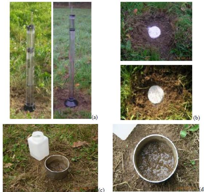
Figure 3.9: Dispositif d'infiltrométrie. (a) Infiltromètres à disque ; (b) Préparation du sol avec sable de contact ; (c) Essais Beerkan (Lassabatère et al., 2010)
