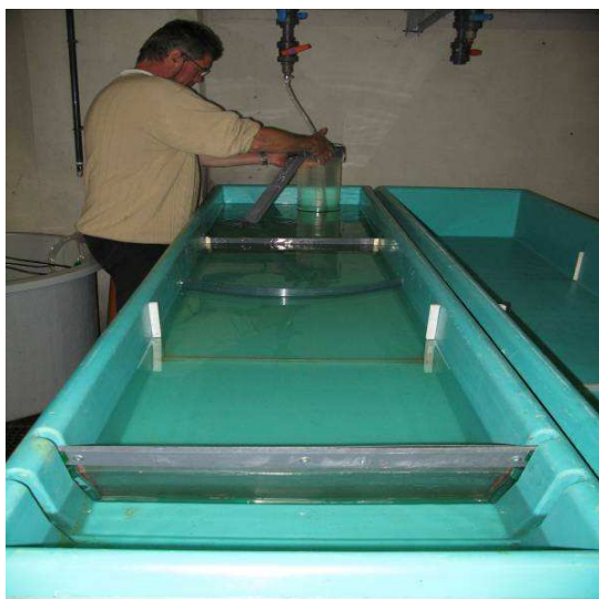
Figure 18 Dispositif d'éclosion et larve à l'éclosion
