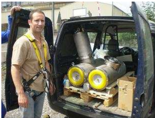
Photo 3 : Répulseur à infrasons utilisé lors des tests de vibration à la centrale de Baigts le 22 mai 2008
