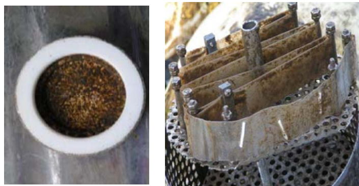
Figure 10 : Biofouling observé sur un Chemcatcher et une SPMD.
