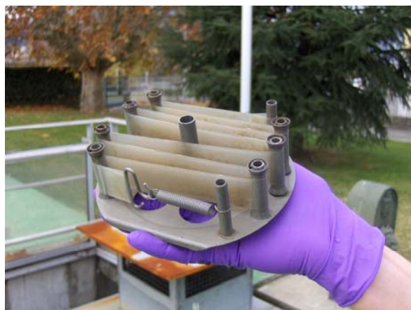
Figure 23 : Photo d'un SPMD sur un support d'exposition in situ
