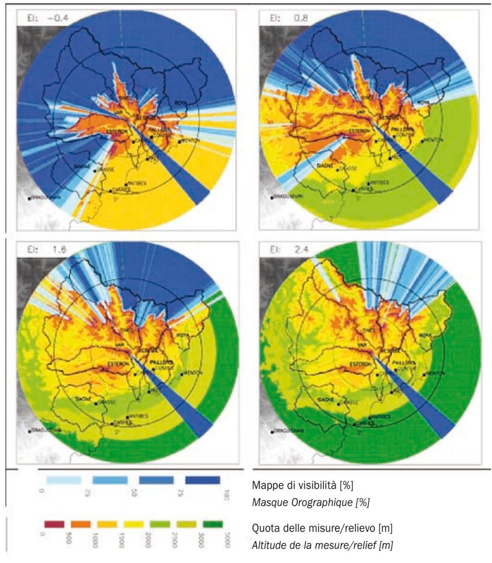
**Figura 1.5** - Mappe di visibilità del radar HYDRIX a Mont Vial (Novimet).**Figure 1.5** - Masque Orographique du radar HYDRIX sur Mont Vial (Novimet).
