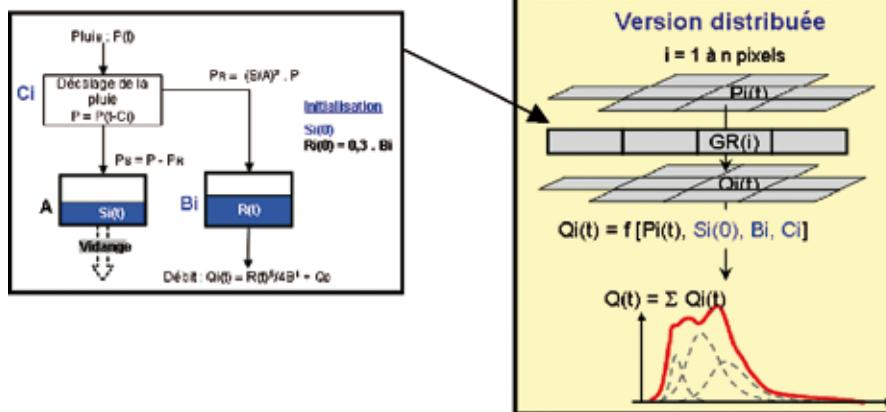
Figura 5.2 - Struttura del modello idrologico distribuito GRD
