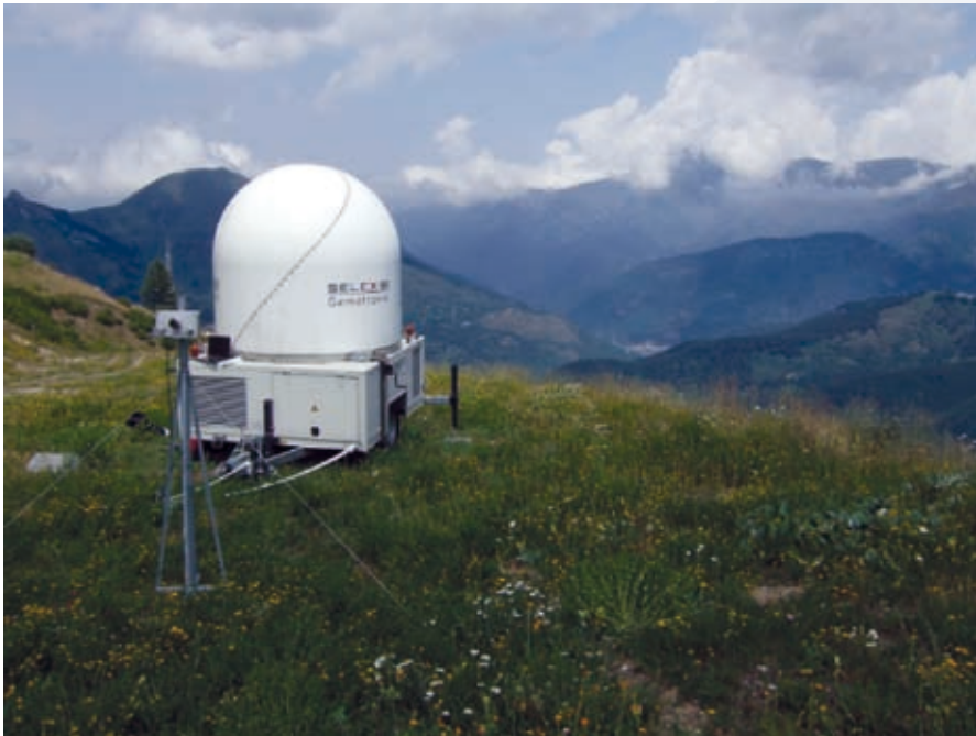
Figura 3.3 - Radar in banda X e disdrometro collocati sul Colle di Tenda, estate 2010.
