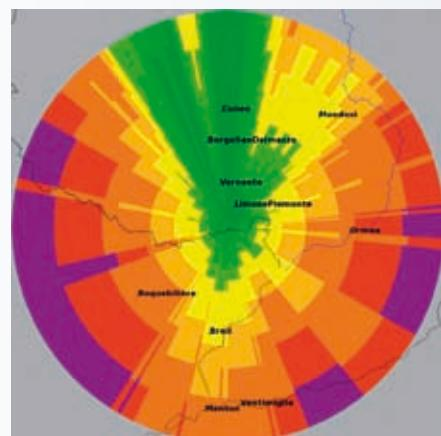
**Figura 4.1** - il radar in banda X trasportabile sul Colle di Tenda (sinistra) e la mappa di visibilità radar dal Colle (destra); è visualizzata l'altezza del primo fascio libero sul livello del mare: colore verde (1000-3000 m), giallo-arancione (3000-9000 m).
