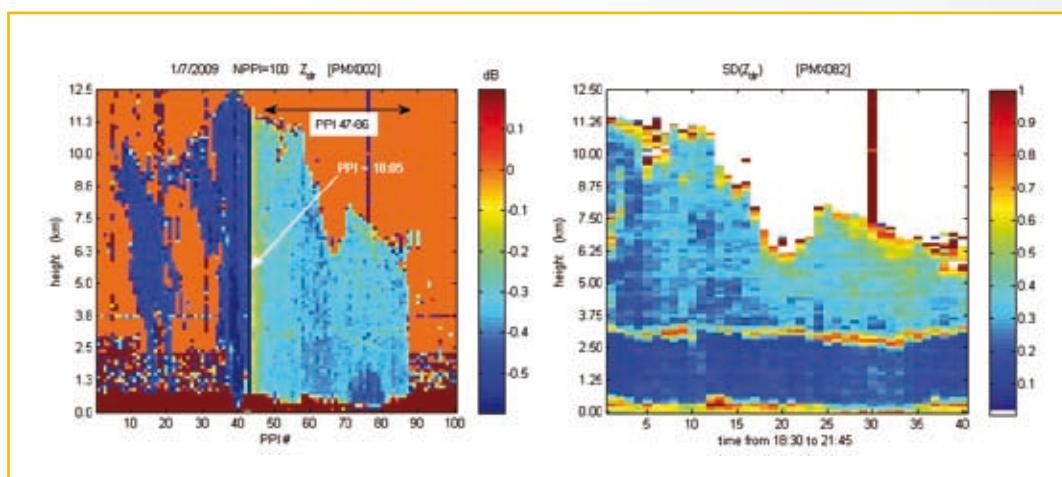
**Figura 4.9** - Valore medio (sinistra) della riflettività differenziale e standard deviation (destra) calcolata per ogni PPI al variare della quota per i dati ARZ dataset del primo luglio 2009. Si noti la discontinuità nelle misure attorno all'PPI n. 45 dovuto a un'interruzione di alimentazione.
