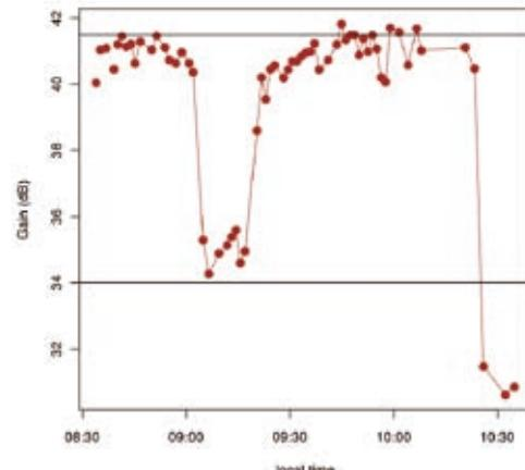
**Figura 4.8 - Sinistra:** il radome del radar in banda X bagnato dall'irrigatore. **Destra:** la serie temporale dell'aumento durante la calibrazione con la sfera metallica. La caduta nella potenza corrisponde al periodo di irrigazione del radome.
