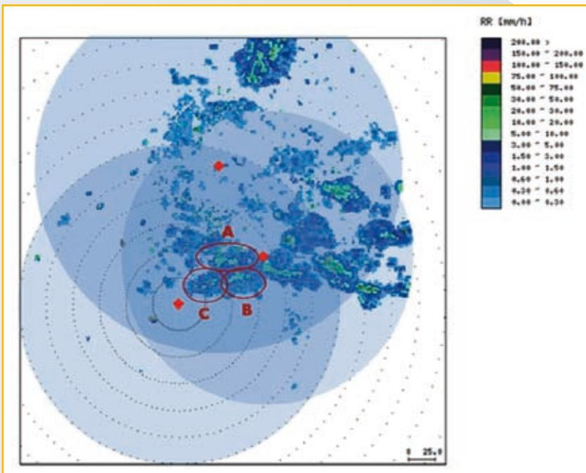
**Figura 4.15** - Stima di precipitazione (in mm/h) misurata il 19/06/2010 alle 10 UTC per radar mosaico. I rombi in rosso indicano la posizione dei tre radar. I rovesci sulla valle Roja sono contrassegnati A, B e C.
