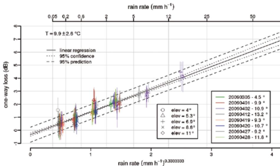
In presenza di un radome idrofobico ci si aspetta una brusca transizione corrispondente al cambiamento di regime del flusso d'acqua, da rigagnoli a flusso laminare. Il radome è stato costruito due anni prima di tali rilevamenti e con ogni probabilità ha perso in tale periodo la sua proprietà di idrofobia a causa del degrado dei materiali
