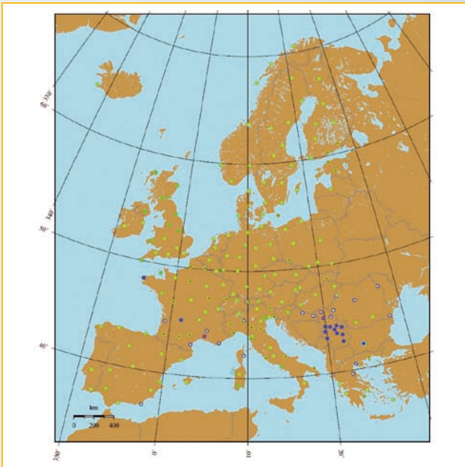
Figura 3.1 - Rete radar dei paesi membri del progetto OPERA. I radar in banda S, C ed X sono contraddistinti rispettivamente dal blu, verde ed azzurro. I sistemi a doppia polarizzazione sono indicati da un piccolo puntino rosso, quelli Doppler da un puntino giallo. Figure 3.1 - Réseau radar des Etats membres du projet OPERA. Les radars en bande S, C et X sont respectivement marqués en bleu, vert et bleu ciel. Les systèmes à double polarisation sont indiqués par de petits points rouges, ceux dotés de la capacité Doppler par les points jaunes.
