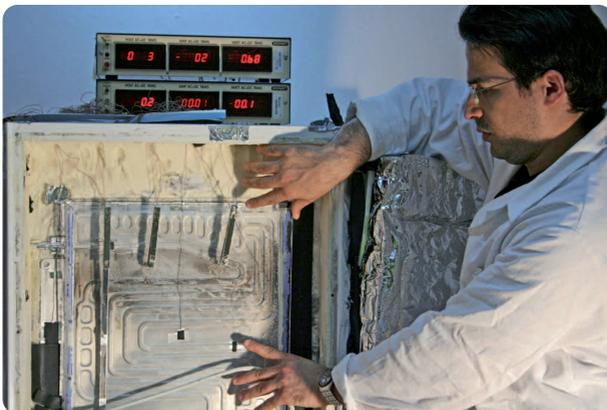
Prototypé réfrigérateur haute inertie ■ Madeleine Carrouée
