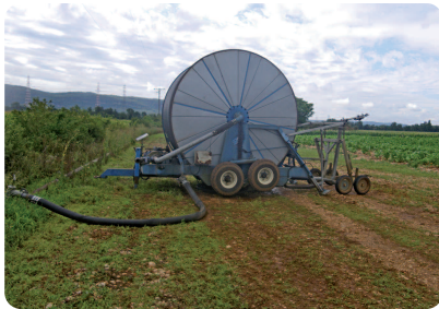
Le système de traction d'un canon enrouleur a un rendement énergétique très faible (2 % à 6 %)
