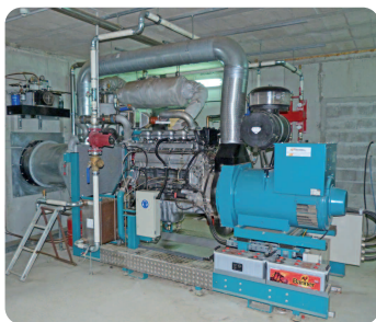
Pilote Irstea de méthanisation et traitement de l'azote de lisier porcin ■ Pierre Rousseau
