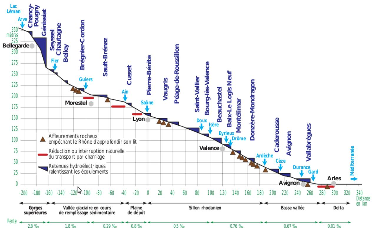
Figure 7 : Aménagements hydroélectriques sur le Rhône français, Hydratec
