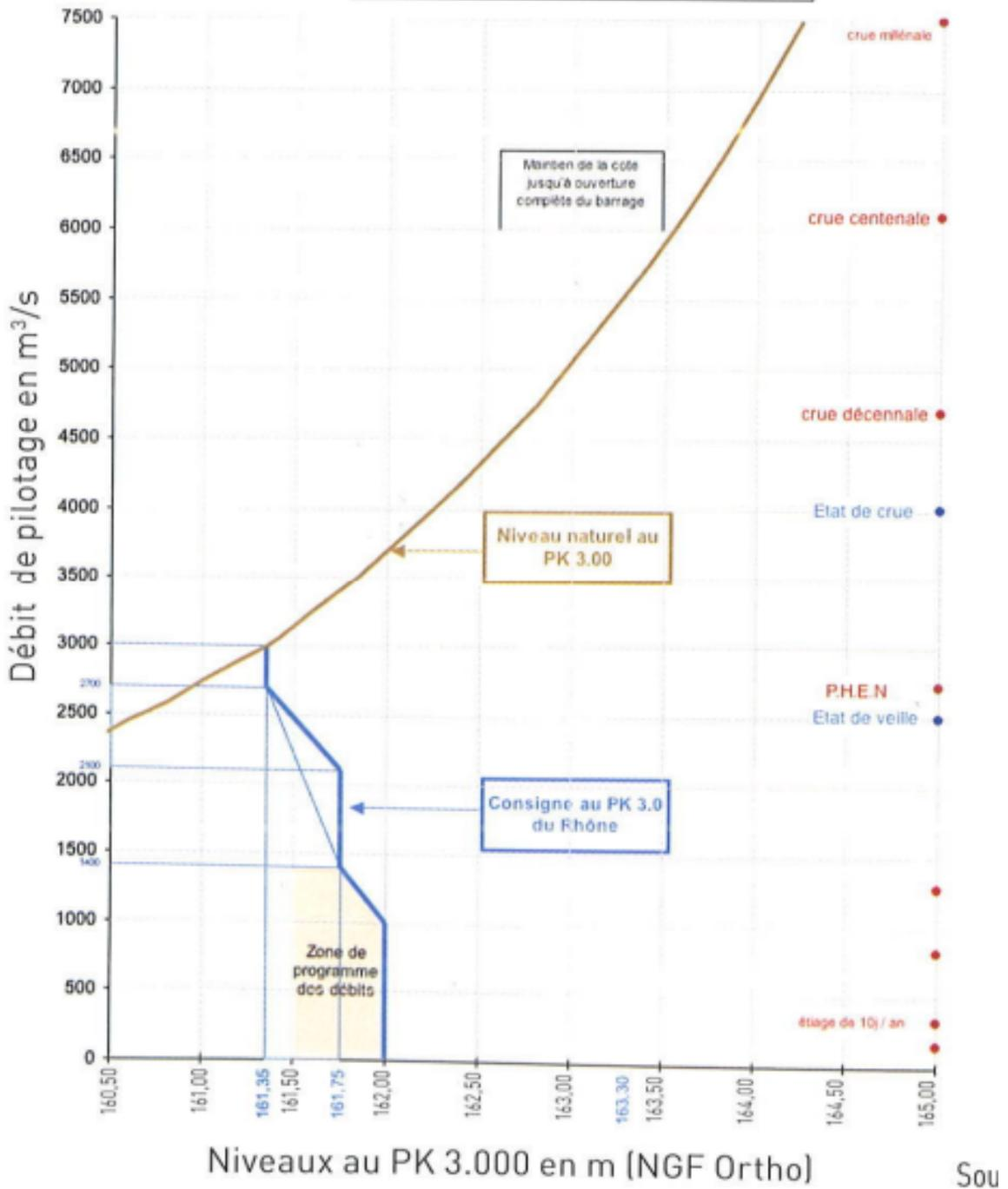
Figure 13 : Aménagement de Pierre-Bénite, exemple de consigne d'exploitation à un point de réglage. Courbe hauteur/débit, CNR.
