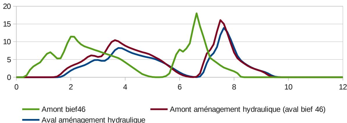
Figure 42: Influence sur la concentration en MES des barrages et aménagements hydrauliques, lors d'une chasse.
