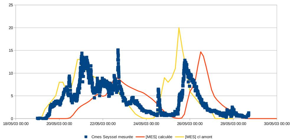
Figure 38: Comparaison entre la concentration en MES mesurée et calculée à Seyssel pour la chasse de 2003 ( $a_{pd} = 0,2$  et  $a_c = 0,0005$ ).
