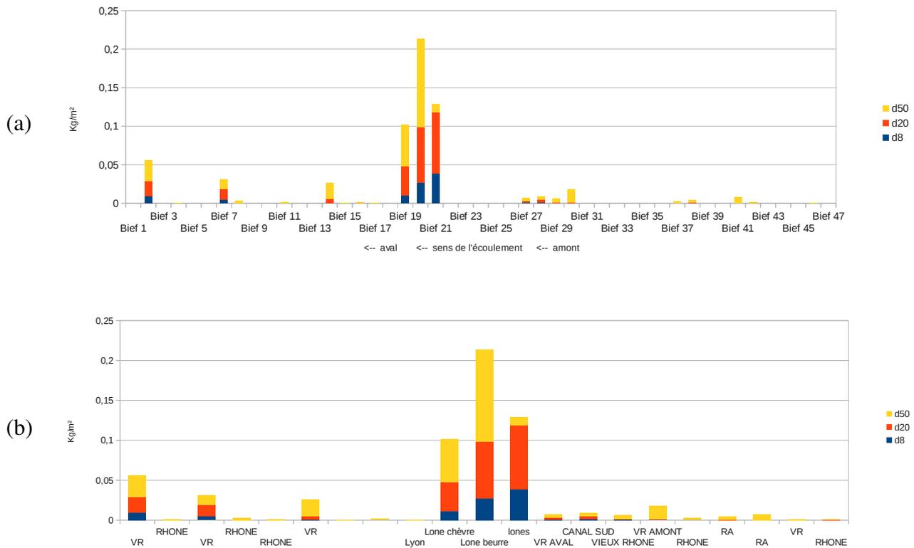
Figure 30: Masses de sédiments déposées en kg/m<sup>2</sup> pour la simulation 1 sur tout le linéaire du Rhône modélisé (a) et sur les biefs où l'on observe des masses de sédiments déposées (b).
