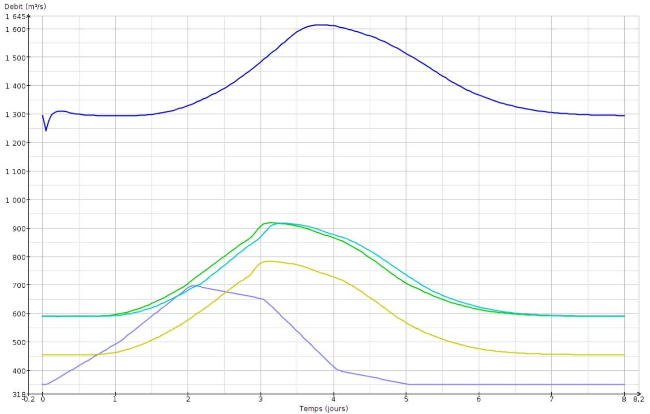
Figure 29: Hydrogrammes issus de Pamhyr-Mage de la propagation d'une crue.
