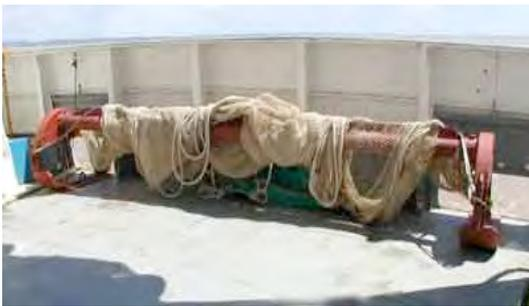
Figure 2 : Chalut à perche de 3 mètres
