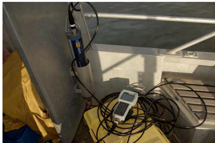
Figure 5 : Photo de la sonde multiparamètres et du boîtier de lecture de surface.
