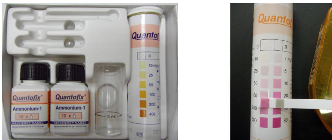
**Figure 1.** Composition du kit de bandelettes «ammonium» et tube de bandelettes «nitrate-nitrite»
