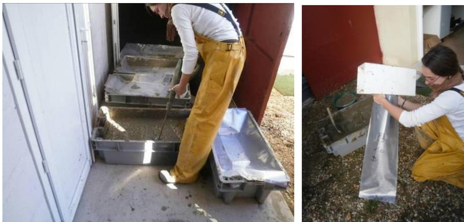
**Figure 12 Homogénéisation des sédiments avant mise en sac et congélation**
