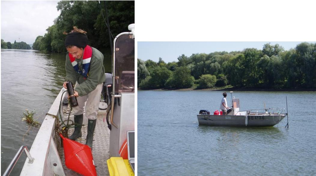
Figure 75 Déchargement des informations enregistrées sur un hydrophone fixe par connection Blue tooth (g) et tracking mobile (d)
