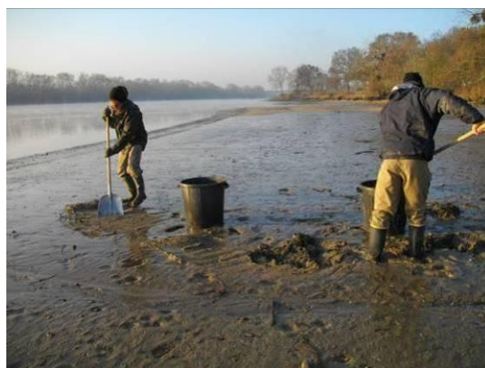
Figure 11 Prélèvement de sédiments sur la vasière d'Oissel : zone intertidale de l'estuaire amont de la Seine
