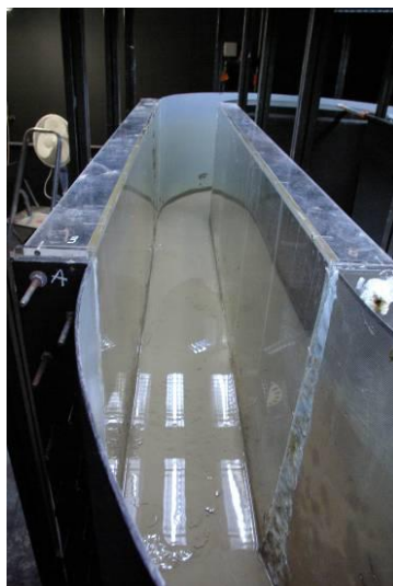
Figure 13 Vue d'un chenal après mise en place du sédiment
