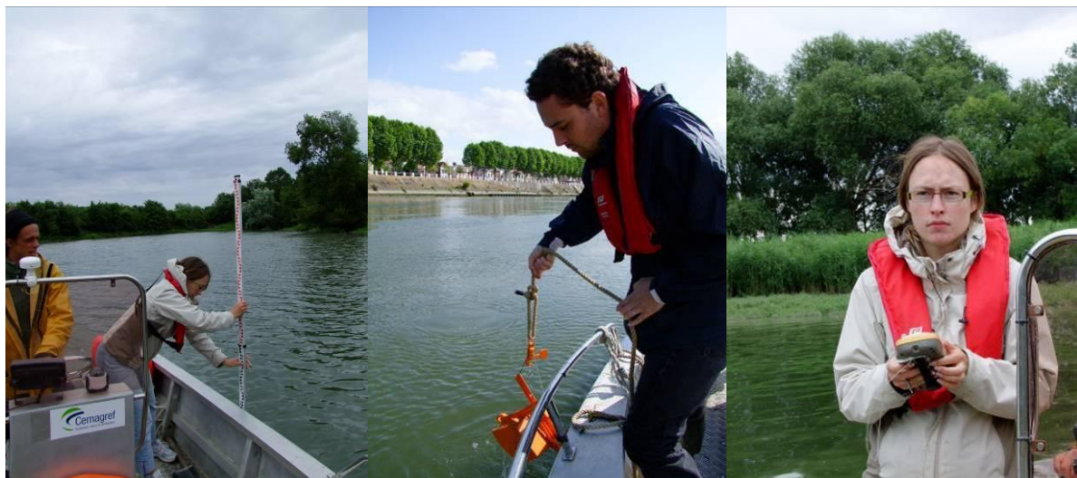
Figure 67 Mesures complémentaires des caractéristiques de l'environnement : bathymétrie dans un bras secondaire (g), prélèvement de substrat (centre), relevé de la végétation des berges (d).
