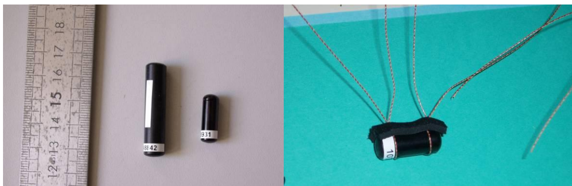
Figure 69 Emetteurs V9P-6L (à gauche) et V7-2L (à droite)
