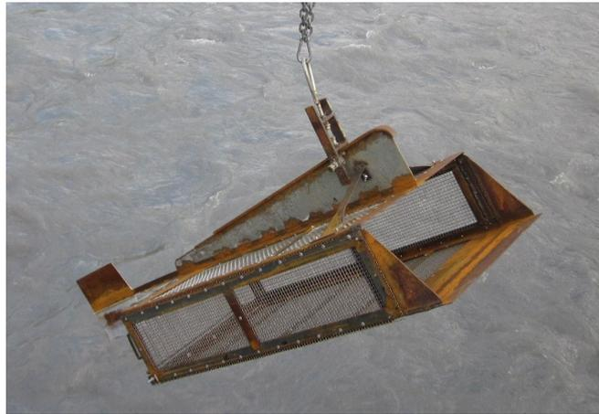
Figure 2 : Ehrenberger suspendu avant mise à l'eau
