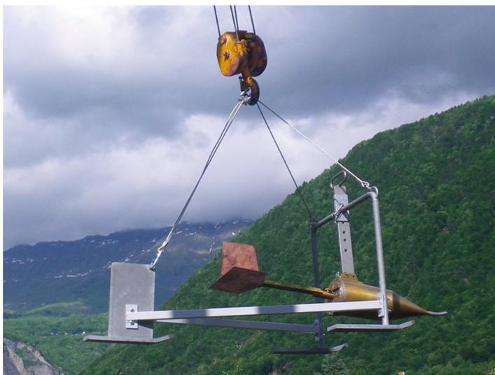
Figure 4 : Bouteille de Delft suspendue avant mise à l'eau
