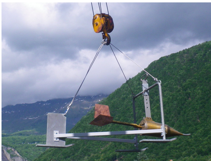
Figure 4 : Bouteille de Delft suspendue avant mise à l'eau
