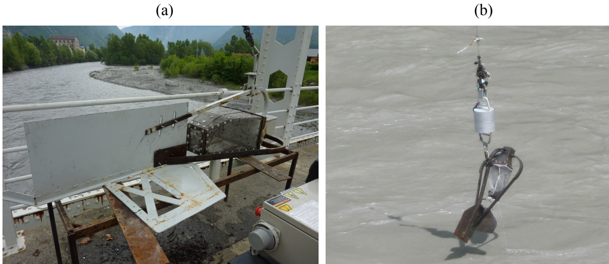
Figure 1 : Préleveurs Helley Smith d'ouverture 152 mm (a) et 75 mm (b)
